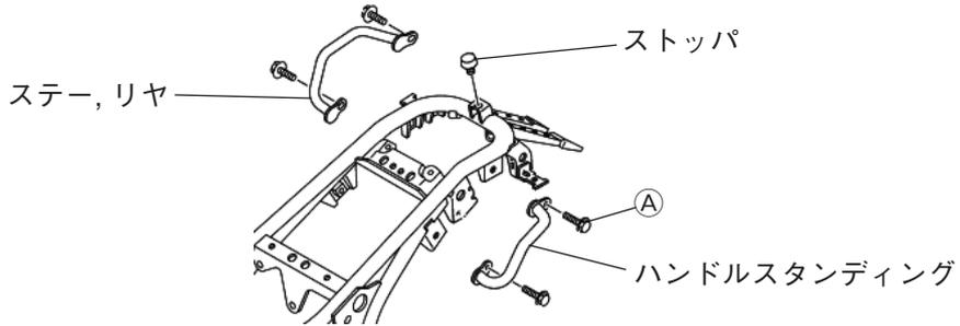
3. ステーキャリア1③・2④をハンドルスタンディング、ステア、リヤが組み付いていた位置に、スタンダード車のボルトAを使用して組み付けます。
