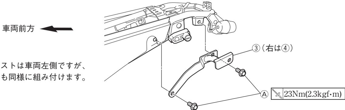
4. アッパープレートステア⑤とロアプレートステア⑥を車両フレームに組み付けます。下側からワッシャ⑱をはさんでフランジボルト⑰で仮止めし、側面中央をフランジボルト⑰で固定します。
