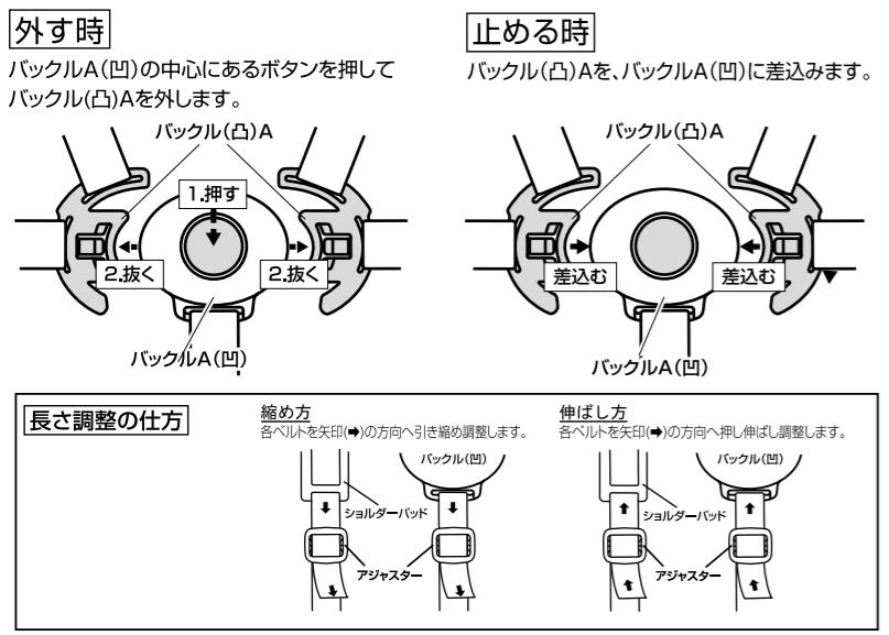
装着後は必ずしっかりと固定されているか上下左右にゆすって確認してから走行して下さい。
