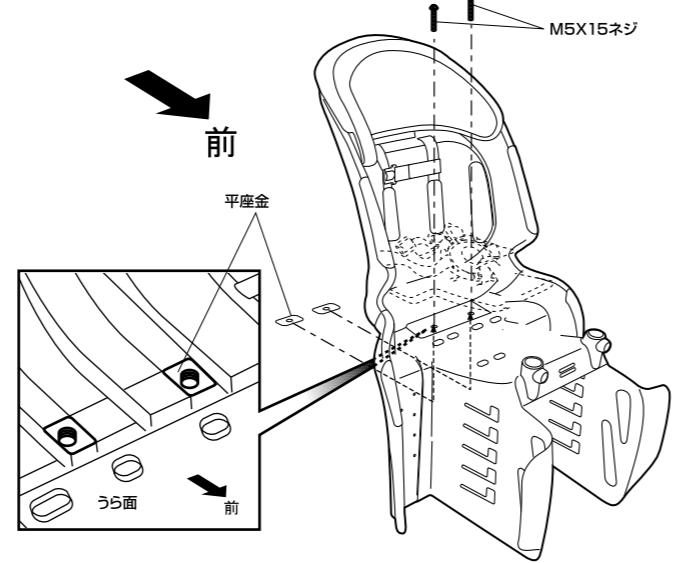
③ 背もたれ部と股部のつなぎ目の両端を平座金とネジM5X35で固定します。
