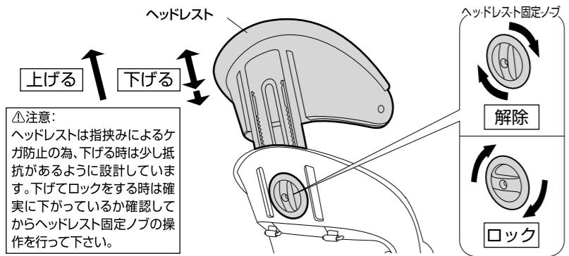
ヘッドレストは、お子様が子供のせに着座した時に側頭部の保護部分がお子様の頭部の中心より高くなるように調整して下さい。
