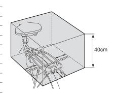
※1:リヤキャリアの「クラス」表示とは、リヤキャリアが許容する最大積載重量を示しています。
