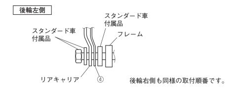
リアキャリアの内側にあるボルトとRドロヨケステー④が5mm程度すき間が空くようにリアキャリアを取り付けてください。
