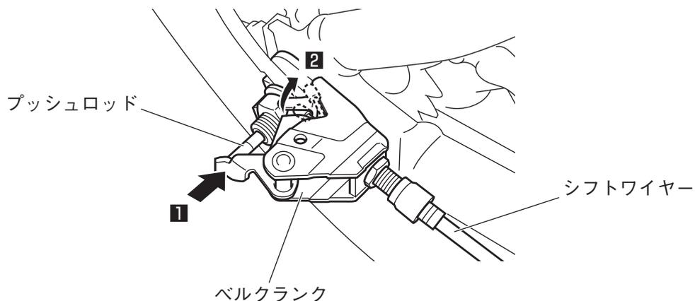
4. リアハブ軸の左右ナット、ワッシャー、プッシュロッド、泥よけステー、サイドスタンド、スペーサー、ベルクランク、回り止めを外します。
