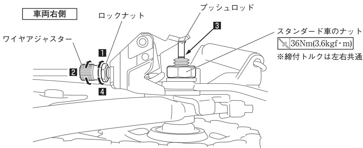
9. ベルクランクカバーをスタンダード車と同じように組み直します。
