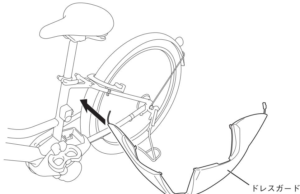
3. 下図を参考に、フックを3ヶ所固定し、ジョイントを連結してドレスガードを取り付けます。
