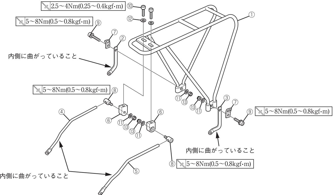
2. 仮組みしたキット部品を車両に取り付け、リアキャリア①の位置を水平になるように調整します。
