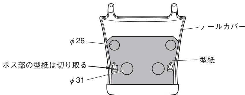
4. 孔を空けたテールカバーを間にはさみ、タンデムシートとアンダーキャリア②をスタンダード車のナットとスクリューで取り付けます。
