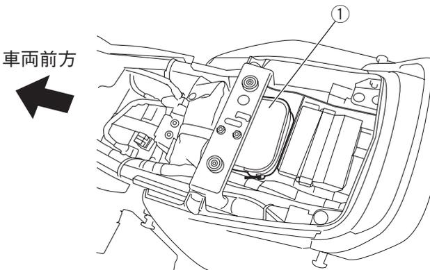
**ビッグスクーター** 面ファスナーをシートボックス内に貼り付け、ケース①裏面の面ファスナーと貼り合わせます。
