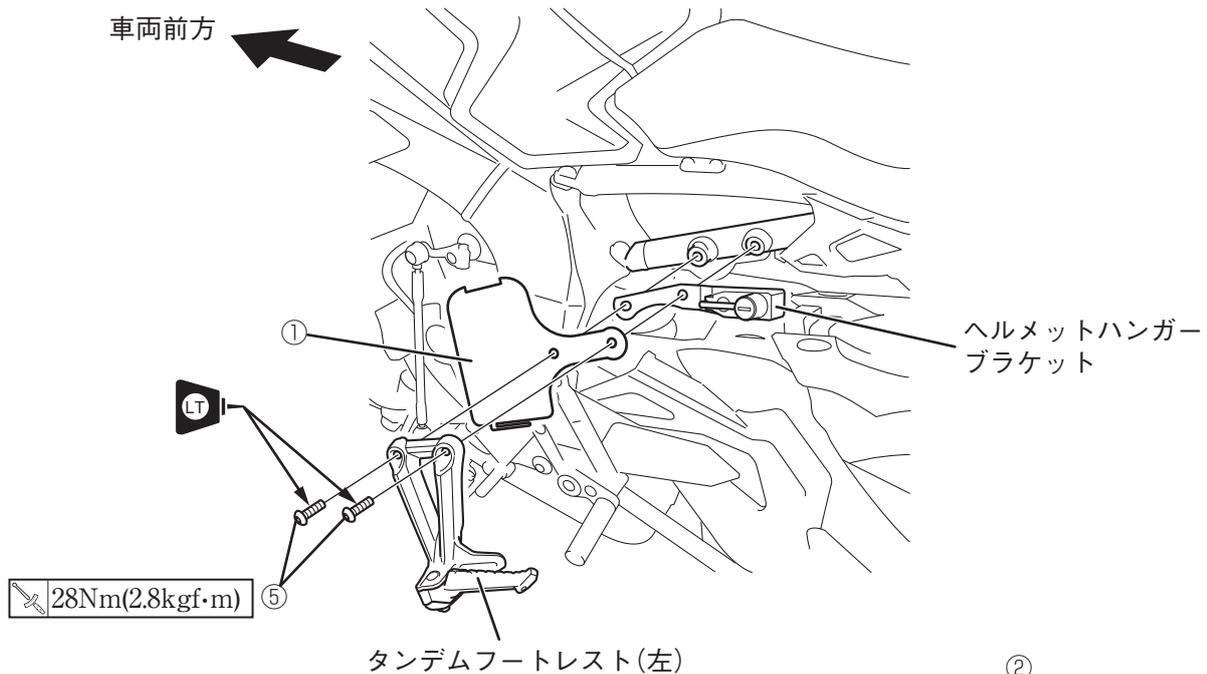
3. カバーロックASSY.②の孔にETC車載器の配線を通し、カバーロックASSY.②のベルトをブラケット①のフックに通します。
