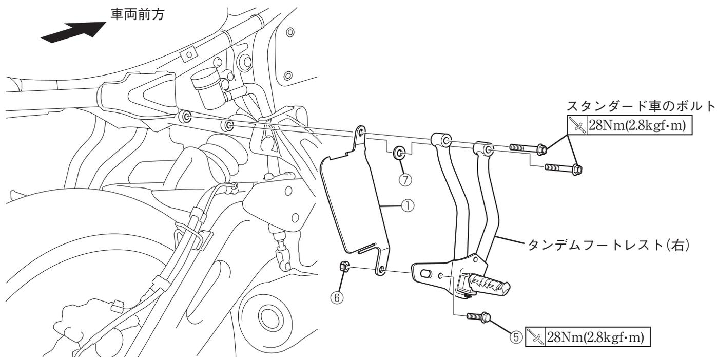
3. カバーロックASSY.②の孔にETC車載器の配線を通し、カバーロックASSY.②のベルトをブラケット①のフックに通します。
