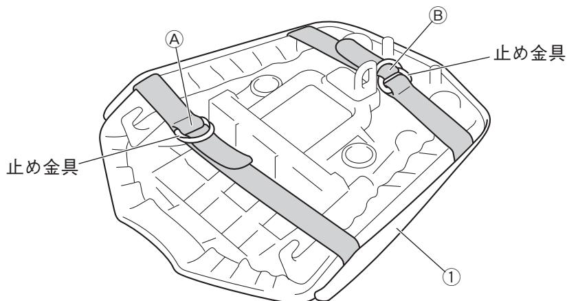
4. タンデムシートを車両に組み付けます。□
