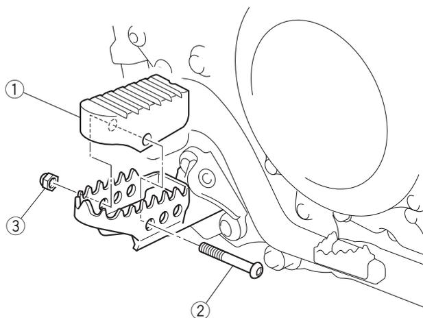
図は右側の取り付けを説明しています。左側も同様に取り付けてください。
