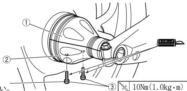
※必ず後側のボルトを先に締め付けてください。
