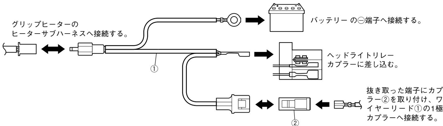
5. ヘッドライトリレーカプラーにホルダーを付け直します。
