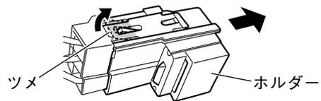
3. 精密マイナスドライバーを使用して、ヘッドライトリレーカプラーの抜け止めを外しながら端子を一本抜き取ります。
