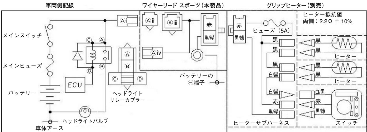
ヘッドライトリレーカプラーの(A)極から端子(A i)を抜き、カプラー(A ii)に挿入し、さらにカプラー(A iii)と接続する。
