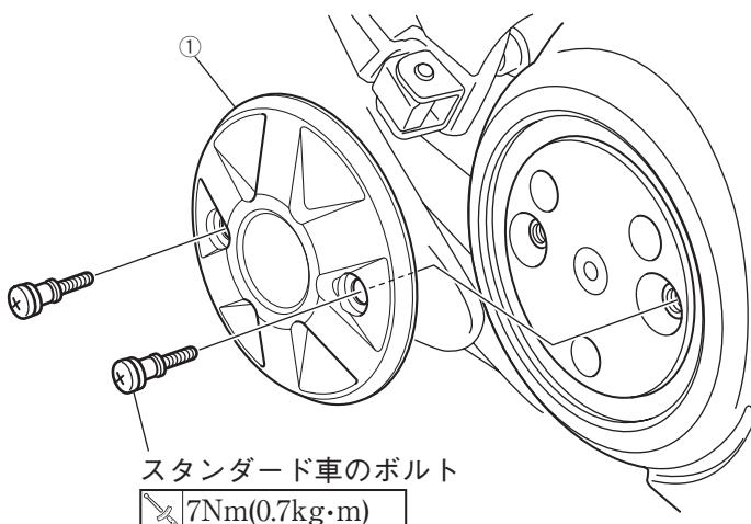
※イラストは車両右側ですが、左側も同様に組み付けます。
