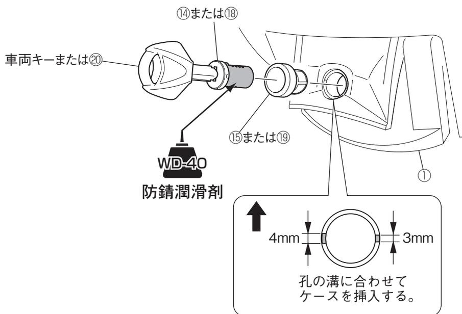
3. トップケース付属のストッパー⑤とスクリュー④でローター⑭(または⑱)を固定します。スクリュー④には必ずネジロックを塗布してください。
