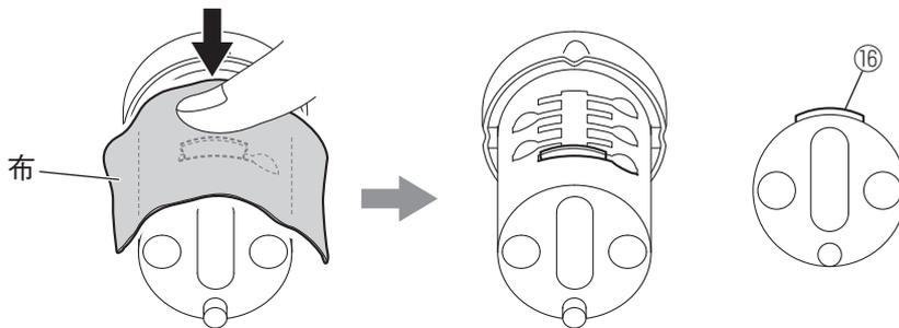
9. 同じように残りの溝へタンブラ⑩とバネ⑪を取り付けます。
