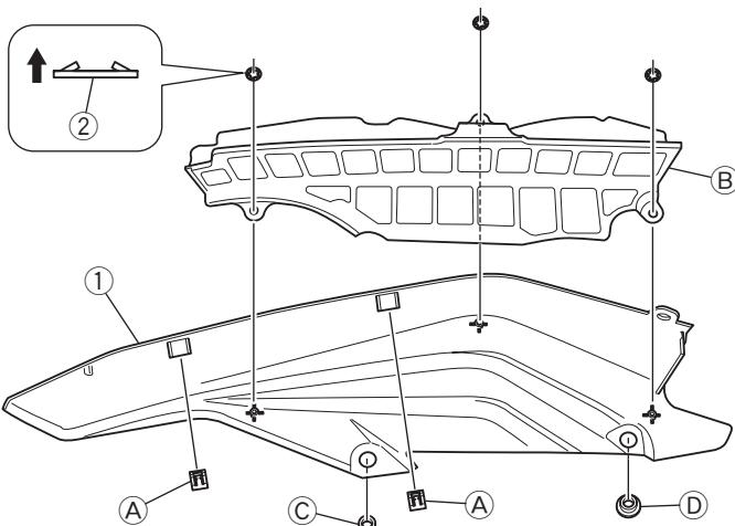
3.スタンダード車のボルト・リベットを使用して、ベルトカバーを車両に組み付けます。
