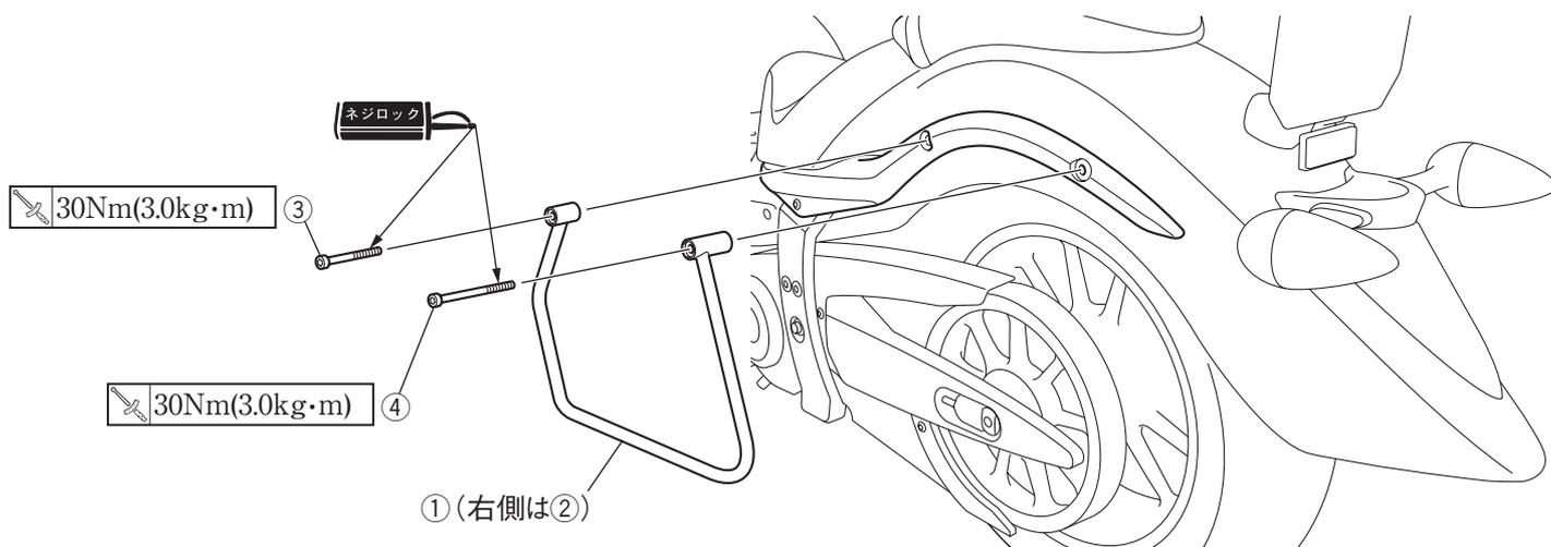
※イラストは車両左側ですが、右側も同様に組み付けます。
