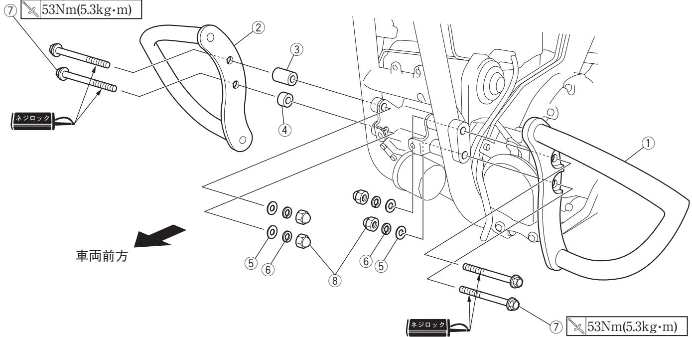
3. 取り外したブラケットを組み直します。 (締め付けトルク : 30Nm <3.0kg · m> )
