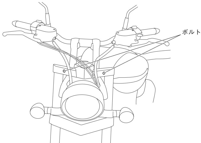
2. ブルバードスクリーンASSY.①と車両の間にスペーサー②をはさみ、ボタンヘッドボルト③で固定します。
