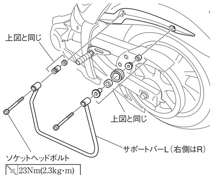
3. バックレストステー⑬とサイドアームL①・R②をプレート⑬とボタンヘッドボルト⑯で仮組みします。
