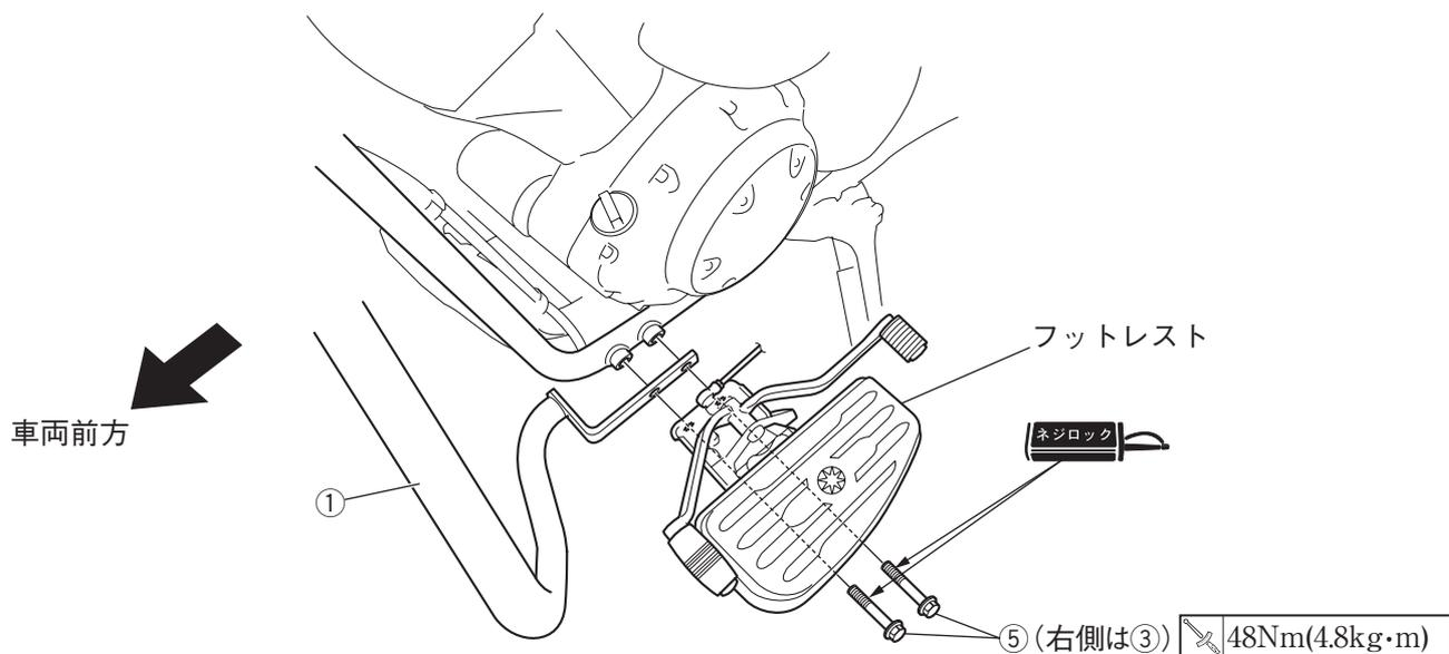
※イラストは車両左側ですが、右側も同様に組み付けます。
