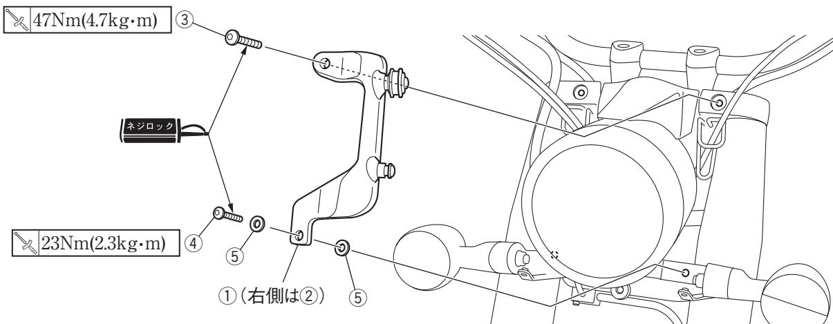
\* イラストは車両左側ですが、右側も同様に組み付けます。
