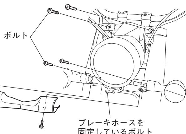
2. マウントL①・R②を車両にボタンヘッドボルト③・④で固定します。下側はワッシャー⑤でマウントL①・R②をはさみます。
