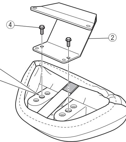
5.組付方法4で組み付けたシートバックASSY①とバックレストステー②をボルト③でハンドルに組み付けます。
