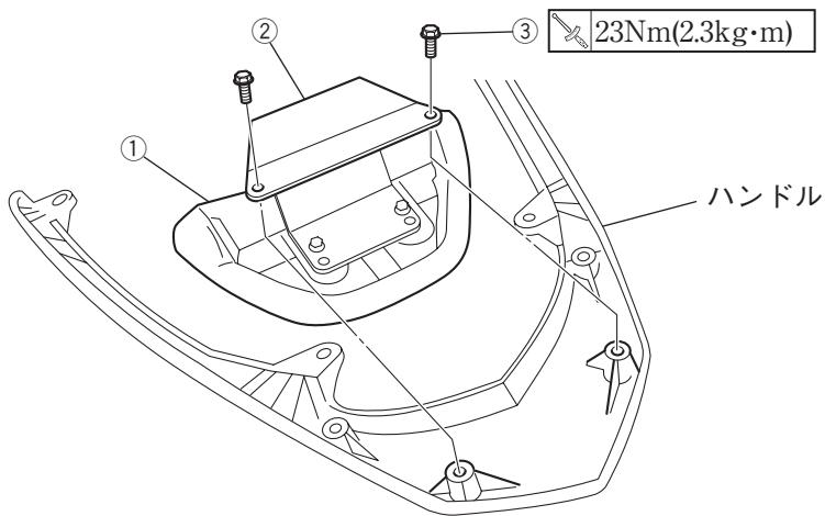
6.スタンダード車のボルトを使用して、元と同じようにハンドルを車両に組み付けます。
