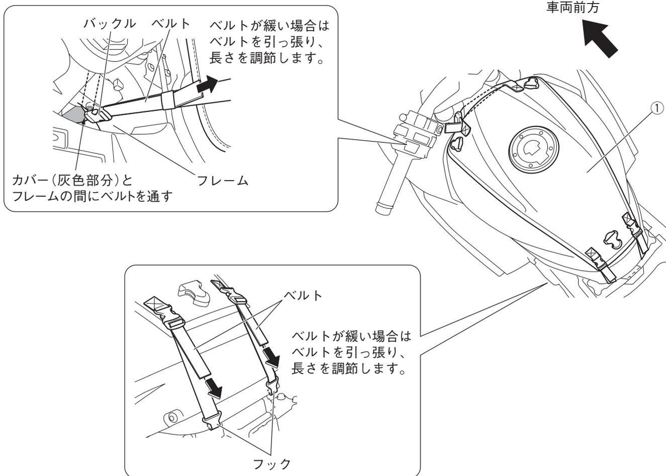
3. ベース①の上にタンクバック②を置き、バックル(3ヶ所)で固定します。
