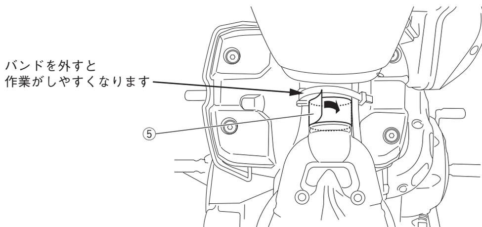
5. スタンダード車のライダーシートと同じように、ベースプレート②の後側の金具を車両の金具に引っ掛け、前側をスタンダード車のボルトで組み付けます。
