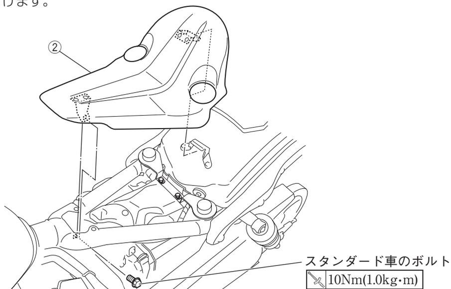
6. クランプ④をダンパーシール⑤が貼り付いている車両フレームの下に配置し、シート①とクランプ④で車両フレームをはさむように、ソケットヘッドボルト⑥とキャップナット⑪で固定します。
