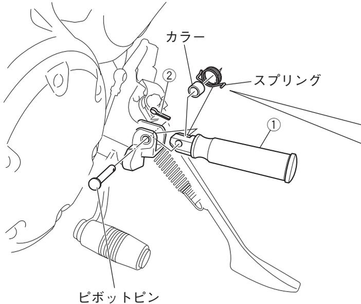
※イラストは車両左側ですが、右側も同様に組み付けます。
