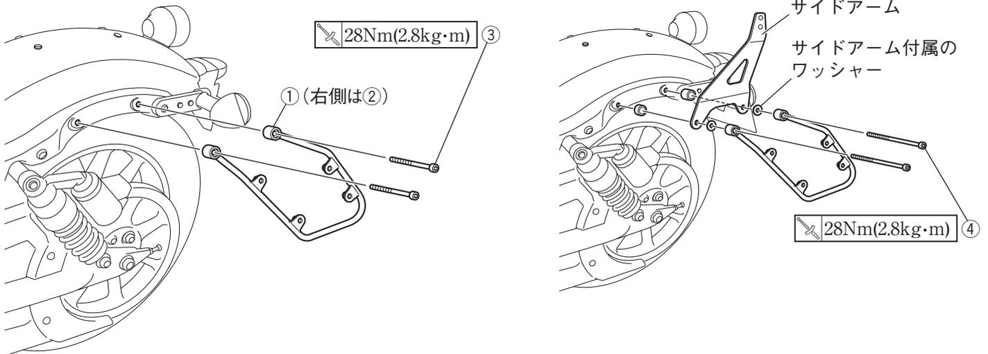
※イラストは車両左側ですが、右側も同様に組み付けます。
