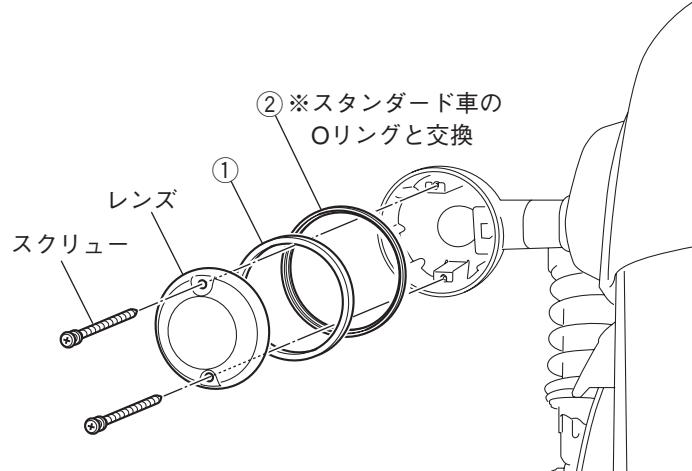
※イラストは車両左後側ですが、右後側及び前側も同様に組み付けます。
