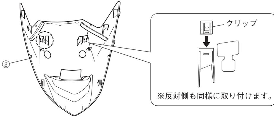
3. ストッパー、ラバー1③・④をパネルコンプリート1②の孔に正面から下図のように入れ、90度回転させます。回転後、ストッパーを引っ掛けます。
