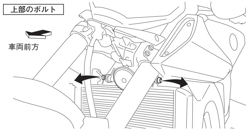
3. 車両左側：上部は取り外したスタンダード車のボルトを使用してラジエターカバーL①を固定します。その際、スタンダード車のワッシャーは使用しません。中央はフランジボルト④で固定します。
