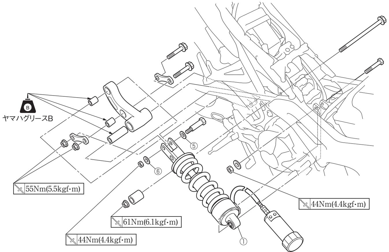
2. スタンダード車の車両左側タンデムステップを取り外し、スタンダード車のヘルメットハンガーステーとブラケット ②を交換します。
