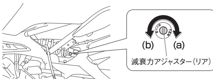
※減衰調整はアジャスターを(a)方向へいっぱい回し(0.5Nmで)たところから(b)方向に回した最初のノッチのある箇所を基点(1 段目)とします。(純正リア減衰調整にノッチはありません)
