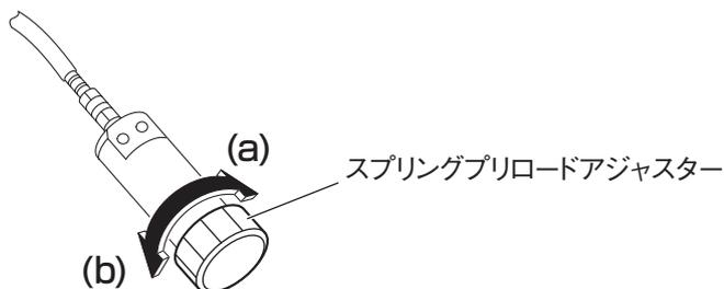
※プリロードはアジャスターを(b)方向に回して、サスペンション本体側の油圧ジャッキが動かなくなったところから(a)方向に回した最初のノッチ位置を基点(1 段目)とします。
