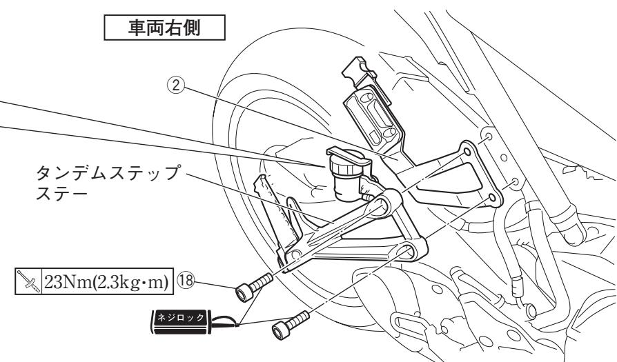
5. タンデムステップステーを一度取り外し、車両フレームとヘルメットハンガーステーの間にステーL①をはさんで、ソケットヘッドボルト⑯で再度組み付けます。
