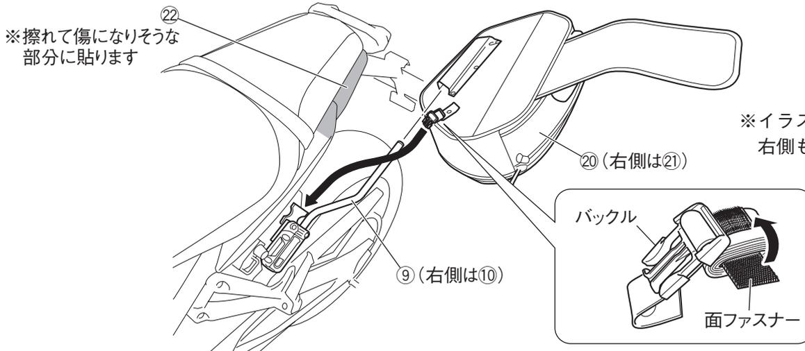
※イラストは車両左側ですが、右側も同様に組み付けます。
