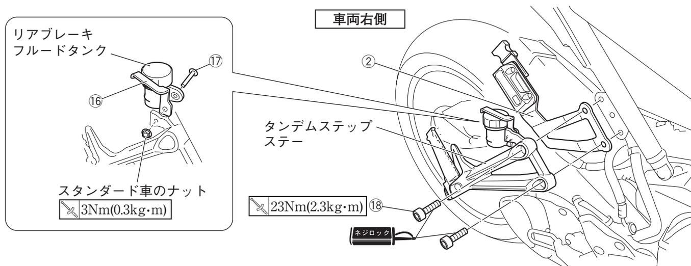
5. タンデムステップステーを一度取り外し、車両フレームとヘルメットハンガーステーの間にステーL①をはさんで、ソケットヘッドボルト⑱で再度組み付けます。
