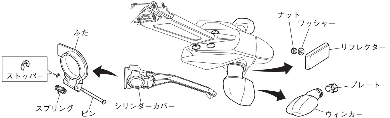
3. 取り外したふた、ピン、スプリング、ストッパーをキットのシリンダーカバー②⑥に組み付けます。
