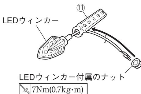
7. ウィンカーとライセンスライト⑥の配線はライセンスホルダーの中を通し、スタンダード車と同じ経路で車両内まで配線します。
