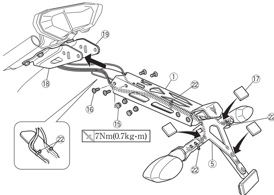
12. スタンダード車と同じように、ウィンカーのカプラーとライセンスライト⑥のギボン端子を車両に接続します。ウィンカーの配線が届かない場合は、延長リード線㉑を使用してください。
