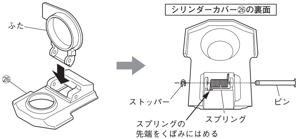
4. ステアL⑱・R⑲でシリンダーカバー②⑥をはさみ、ライセンスホルダーが組み付いていた位置にステアL⑱・R⑲をヘキサゴンボルト⑳とナット⑮で仮止めします。
