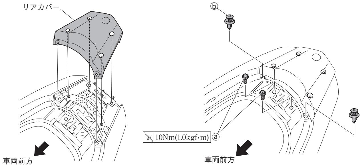
6. キャリア①と車両の間にカラー長②・短③をはさみ、ボタンヘッドボルト④・⑤で固定します。
