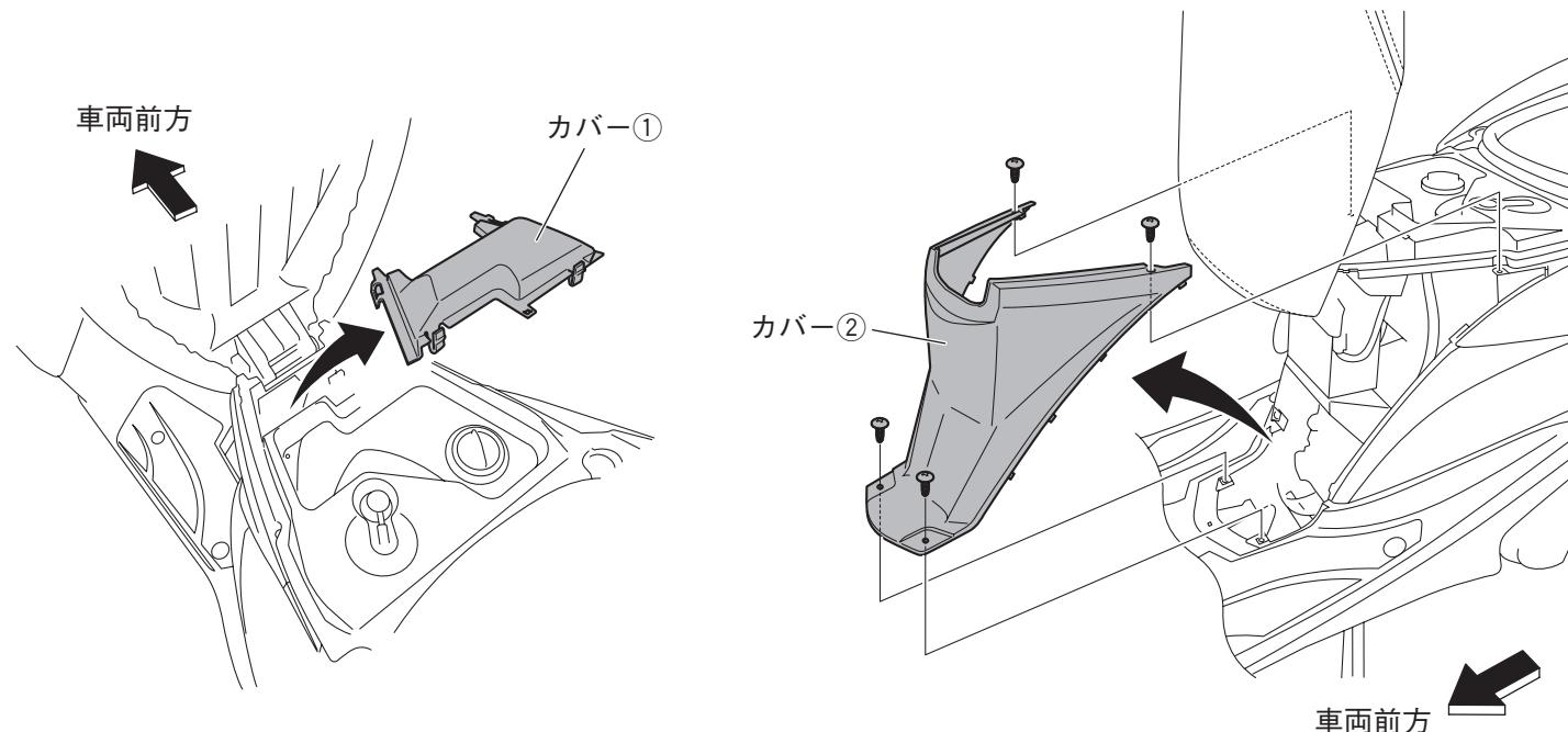
2.スタンダード車のシートを取り外し、スタンダードと同じようにドレスアップシートを組み付けます。
