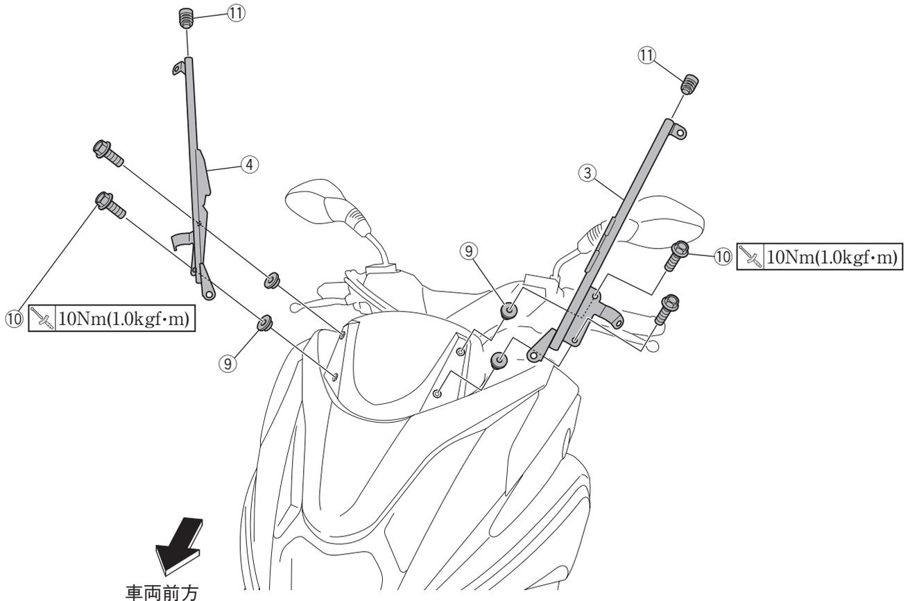
8.スクリーン①をブラケット左③・右④に、ヘキサゴンソケットボルト⑥とナット⑤で組み付けます。
