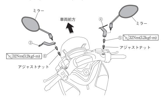
4. ブラケットL③・R④の孔にウェルナット⑦をはめ込み、ナックルバイザーL①・R②をスクリュー⑧で取り付けます。 5. 下図枠内を参考にナックルバイザーの位置を調節し、位置が決まったらミラーを締め付けます。
