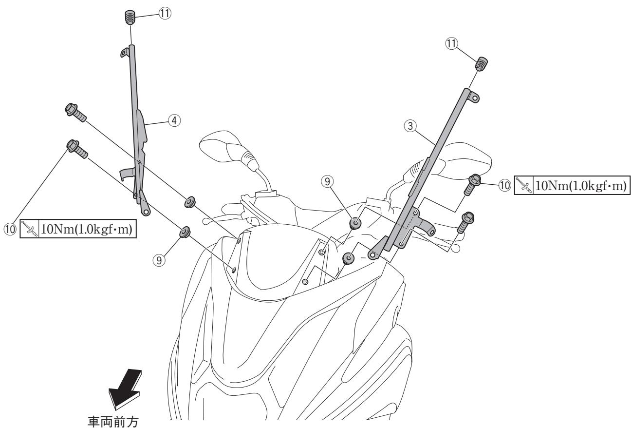
8.スクリーン①をブラケット左③・右④に、ヘキサゴンソケットボルト⑥とナット⑤で取り付けます。
