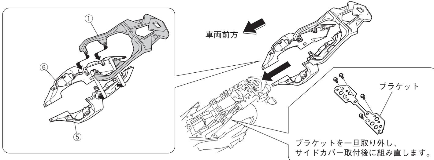
5. キャリア①とサイドカバーL⑤/R⑥を、車両前側はワッシャー③とボタンヘッドボルト②で、車両後側はカラー④とスタンダード車のボルトで取り付けます。
