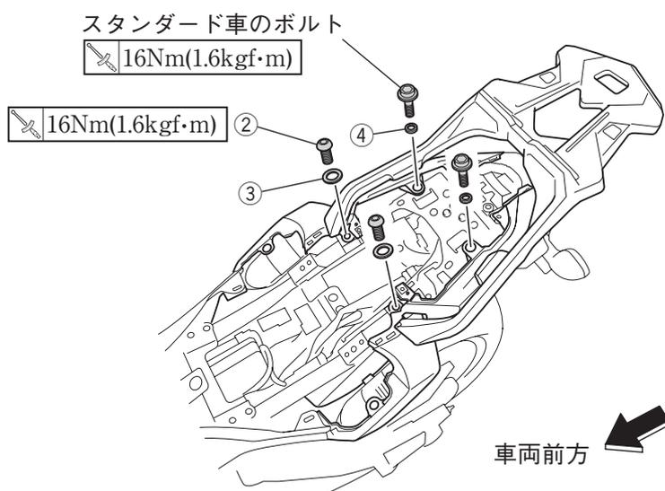
6. 取り外したリアフェンダーカバー、シングルシート下カバー、テールランプ上カバー、タンデムシート、シングルシートを組み直します。☺
