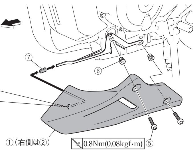
\* イラストは車両左側ですが、右側も同様に組み付けます。
