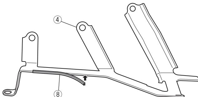
3. エンジンケース底部のボルトを外し、ブラケットL③・R④をスタンダード車のボルトで組み付けます。
