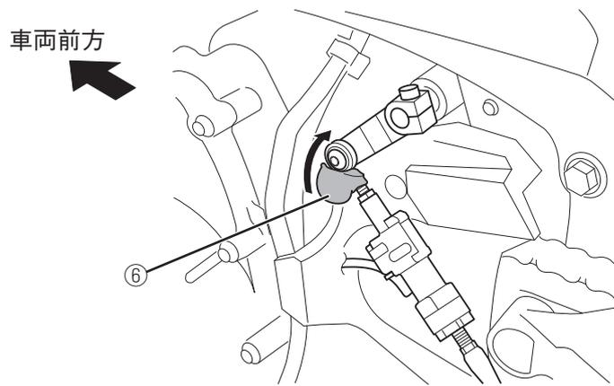
5.シフトペダルの高さを確認し、ロックナット3ヶ所を規定のトルクで締め付けます。
