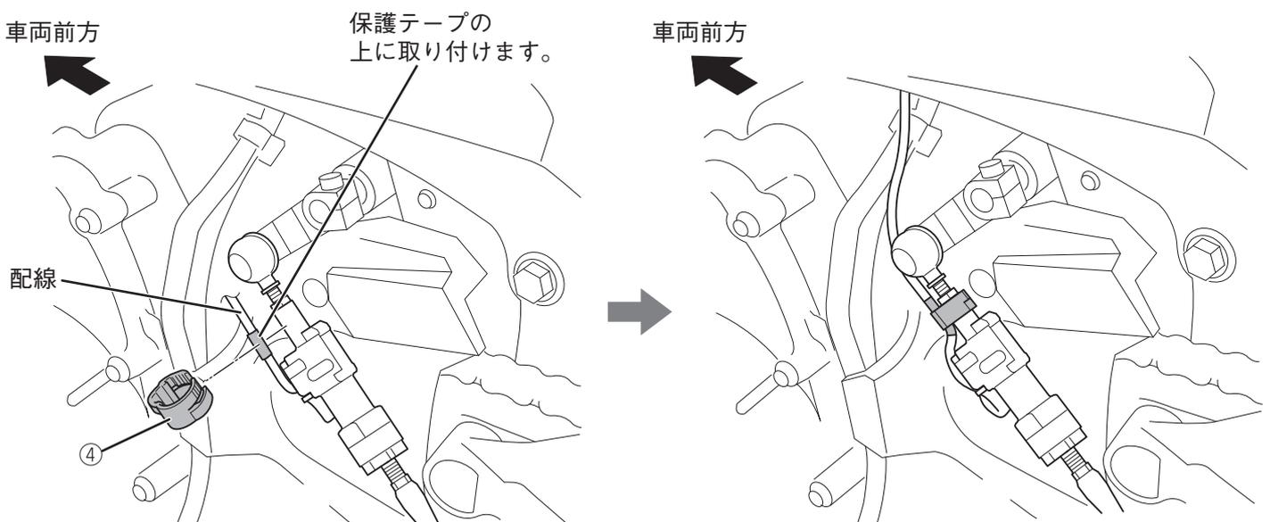
7. タンク下にあるシフトスイッチ用カブラの防水キャップを取り外します。
