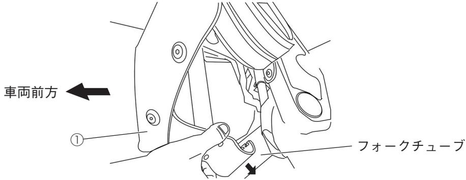
2. マイクロカウルASSY.①のアーム部とインナーランプ②の凹凸を合わせ、ボルト③、ワッシャー⑤、キャップナット④で仮組みします。マイクロカウルASSY.①はフォークチューブの上端に取り付けてください。
