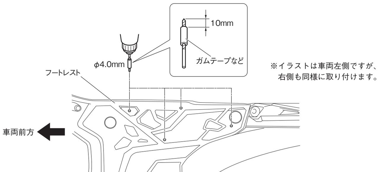
4. プレートL①・R②をあけた孔にタッピングスクリュー③で取り付けます。
