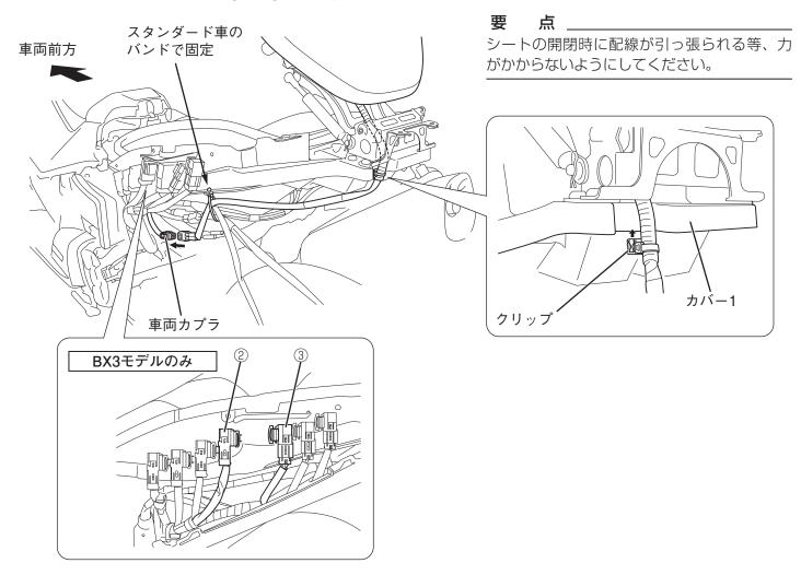
7.取り外したスタンダード車のカバー,サイド5(テールライトごと)、ライセンスホルダー、カバー,トップ、カバー,サイド1・2、カバー,サイド3・4、アシストグリップL・Rを車両に取り付けます。下図のボルトにネジロックを塗布してください。
