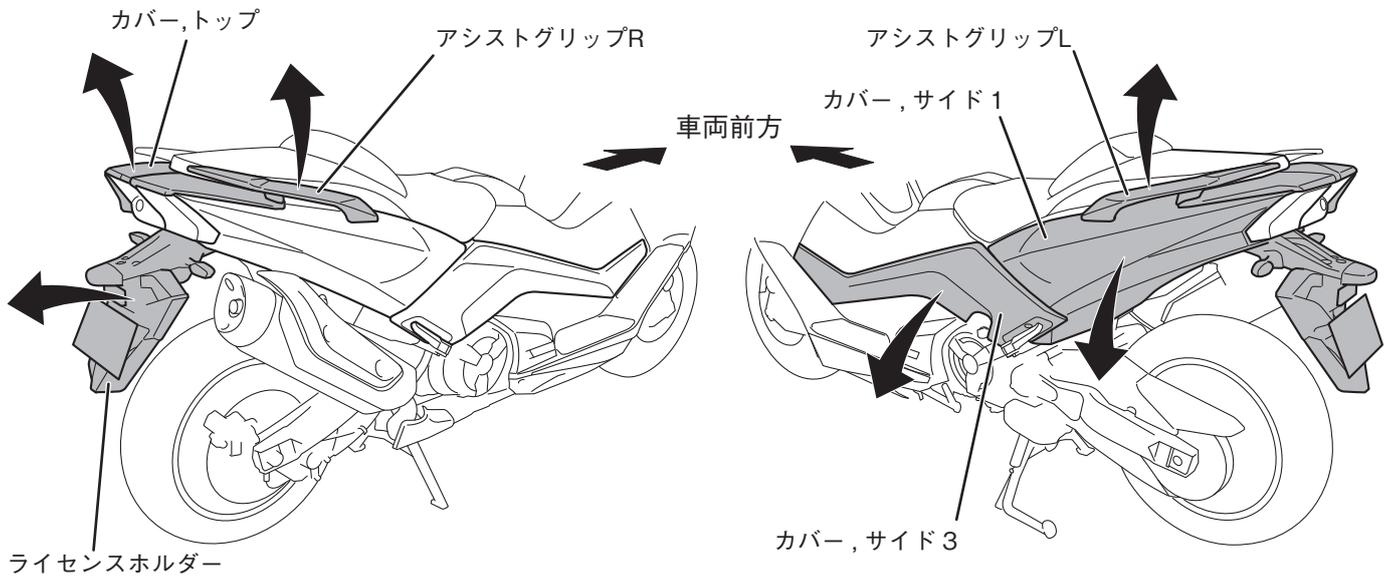
2. ライセンスホルダーからリフレクターとフラッシャーを取り外します。取り外したリフレクターとフラッシャーは、後の手順でキット部品に取り付けます。
