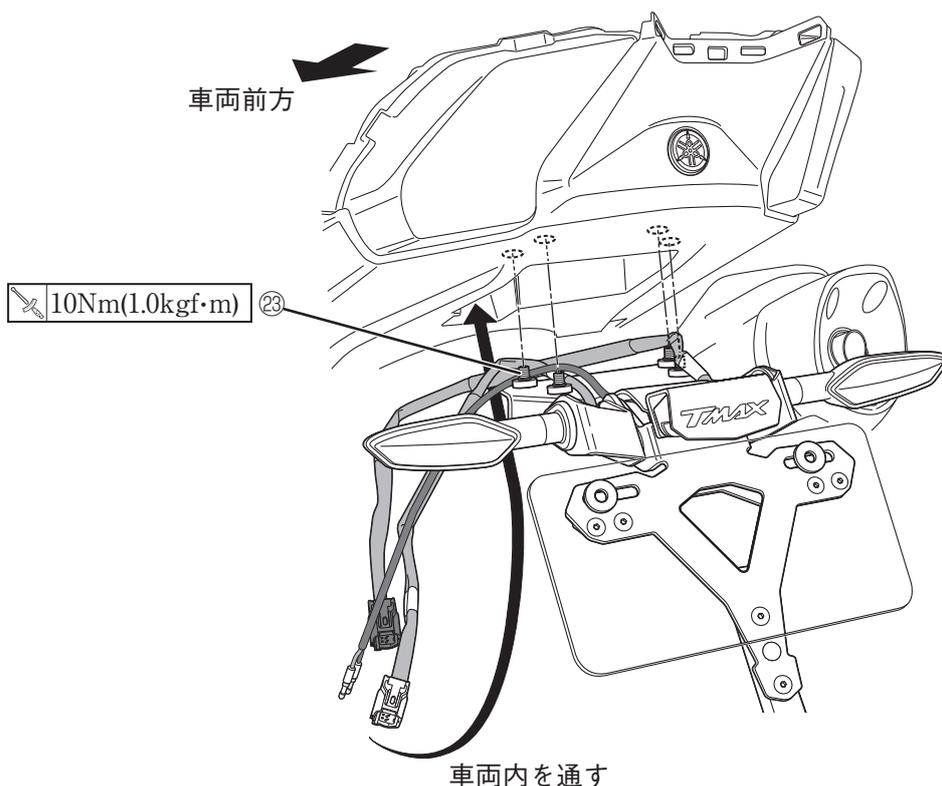
11.フラッシャーカプラとライセンスライトのギボシ端子を車両の電源カプラとギボシ端子に接続します。
