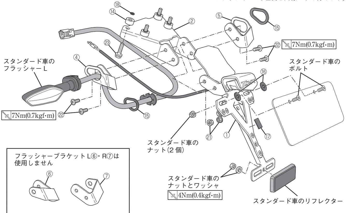
10.フラッシャーとライセンスライトの配線を車両内に通し、組み上げたライセンスホルダーを車両に取り付けます。
