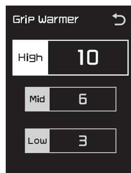
4. メニュースイッチ“MENU”を押します。highに対応する温度の設定値が点滅を始めます。セレクトスイッチで設定温度を決め、“MENU”スイッチを押して確定します。“High”が点滅を始めます。
