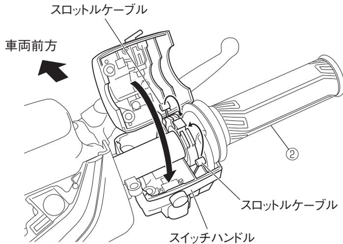
3. グリップウォーマー右②の配線に付いているグローメットをクランプコード⑤の溝にはめ、スタンダード車のブラケット、スタンダード車のスクリュー、スクリュー⑥を使用してスイッチハンドルに固定します。
