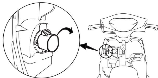
3. USBソケット①をナット②を使用して取り付けます。
