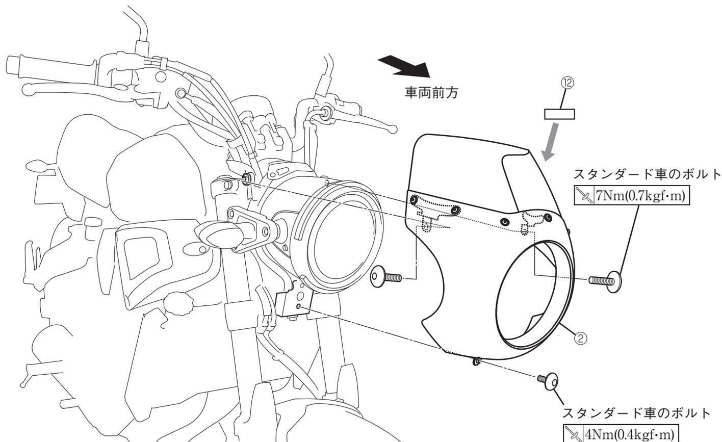
9. ビキニカウル装着後、光軸の調整・確認を必ず行ってください。☞
